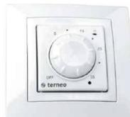
Терморегулятор температуры воздуха обогреваемого помещения при помощи инфракрасных волн или конвекции. Внутренний датчик измеряет температуру в месте установки термостата. Терморегулятор предназначен для поддержания постоянной температуры от 0 до 35 °C. Терморегулятор terneo rol совместим с рамками серии Unica Schneider Electric. Монтаж в стандартную коробку.
